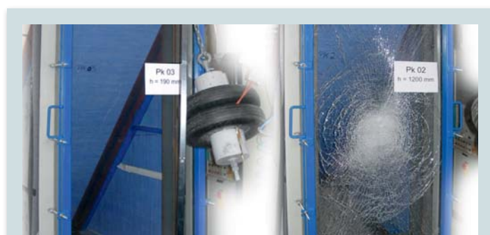
Imagen 2. Antes de que se otorgara al vidrio laminado con intercalarios SentryGlas® el 'Allgemeine bauaufsichtliche Zulassung' ('homologación general para uso en la construcción') en Alemania, fue sometido a una serie de rigurosas pruebas de laboratorio. Además de probar el comportamiento a largo plazo y la resistencia post-rotura, se realizaron una serie de pruebas de impacto con el péndulo llevadas a cabo a baja temperatura desde alturas medias (izquierda, 190 mm) a aumentos de altura considerable (derecha, 1.200 mm). En ambos casos, el film permaneció intacto y los fragmentos de vidrio permanecieron adheridos al intercalario. Fotos: Hochschule München, Fakultät 02, Bauingenieurwesen / Stahlbau
